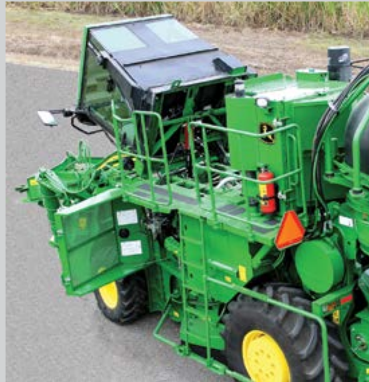
* การซ่อมบำรุงเครื่องยนต์ทำได้ง่ายดาย ด้วยการยกหัวห้องโดยสารจับ
