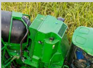
พัดลมระบายความร้อนมาพร้อมกับชุดควบคุมความเร็ว ช่วยให้เครื่องยนต์ทำงานได้ในอุณหภูมิที่เหมาะสมเพื่อประสิทธิภาพสูงสุดตลอดเวลา
