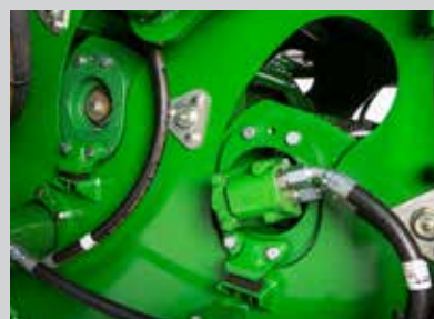
ลูกล่ำเสียง และตลับลูกปืนแบบติดตั้งภายนอกพร้อมแผ่นยางกันกระแทก
