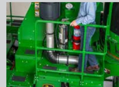
พื้นที่ยืนทำงานมีพื้นผิวที่ป้องกันการลื่นและราวจับเสริมความปลอดภัย
