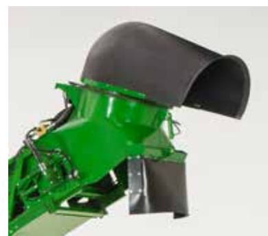
ชุดพัดลมเล็ก ช่วยให้การทำความสะอาดก่อนอ้อย และด้วยการหมุนฝาคกรอบได้ 360 องศา จึงสามารถพ่นเศษใบอ้อยไปในทิศทางที่ต้องการได้
