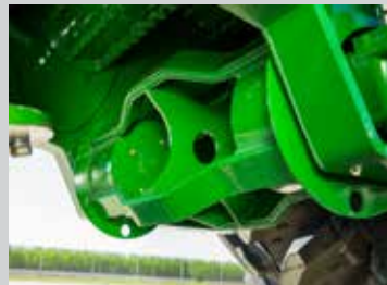
ช่องเปิดลูกส่งลำเลียงท่อนอ้อยช่วยลด ปริมาณดินที่เข้าสู่ตัวรถและการจับตัวของ ท่อนโคลน
