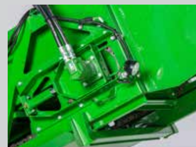
กระบอกสูบจาระบี ช่วยในการปรับความตึงของสายพานล่ำเสียงให้ง่ายขึ้น
